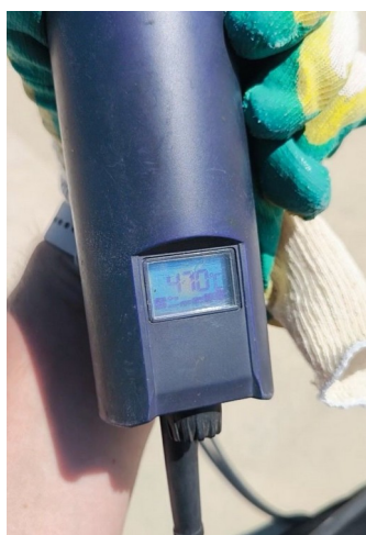
Фото 9. Фен горячего воздуха: рабочая температура 470 °C при пробной сварке (Дефект № 4)
