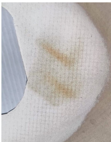
Фото 11. Следы подгорания на подготовленной зоне пробной сварки (Дефект № 4)
